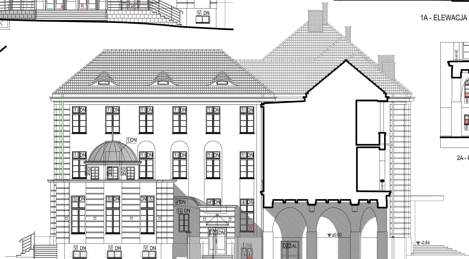
2 - ELEWACJA POŁUDNIOWA Z PRZEKROJEM BRAMY
